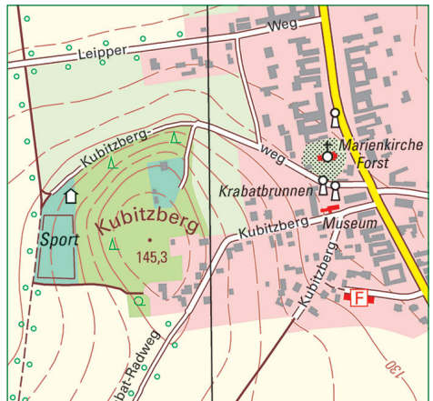
Darstellung der Höhenlinien in der Topographischen Karte mit gestrichelten Hilfshöhenlinien
