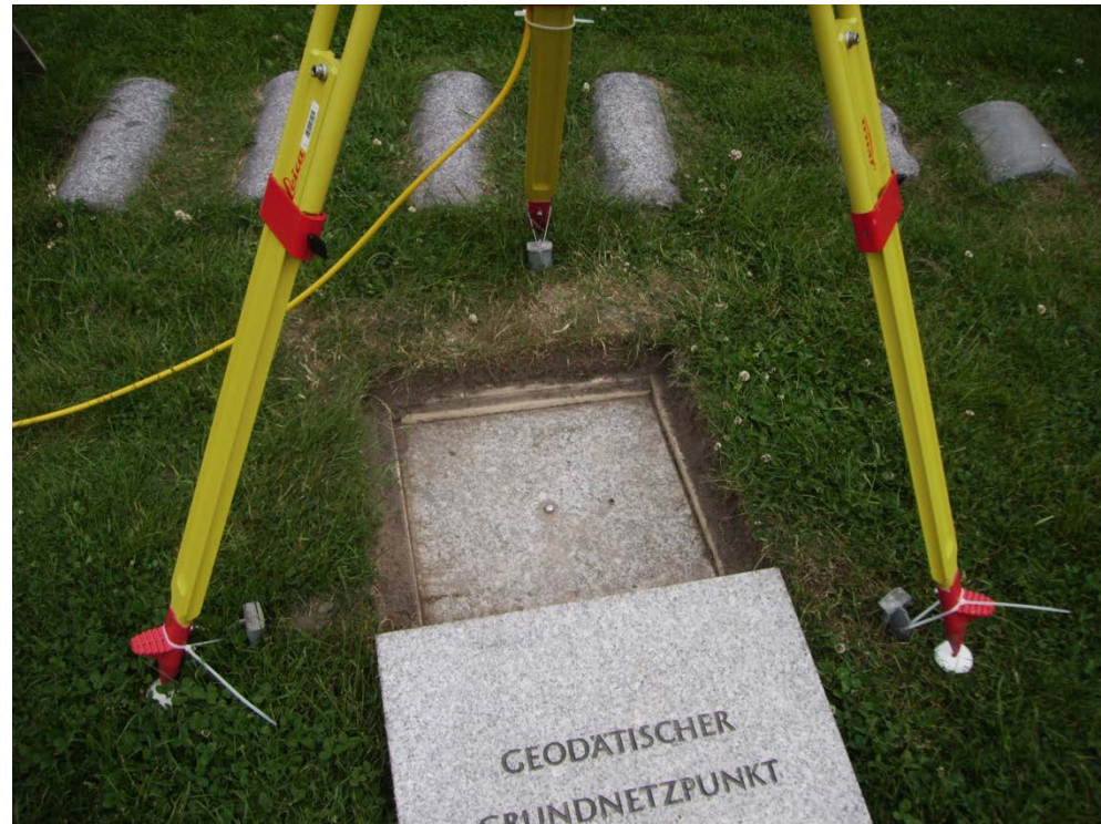
Ein Geodätischer Grundnetzpunkt: Lage-, Höhen- und Schwerefestpunkt
